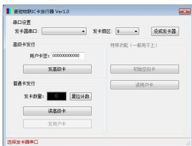
选择对应的串口之后, 点击【打开】, 若设备连接正常, 发卡器会“嘀”一声。
